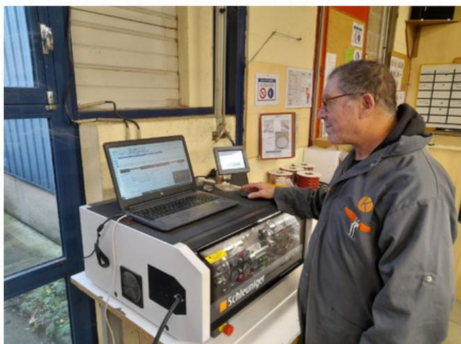
Machine de coupe et dénudage de câbles électriques
