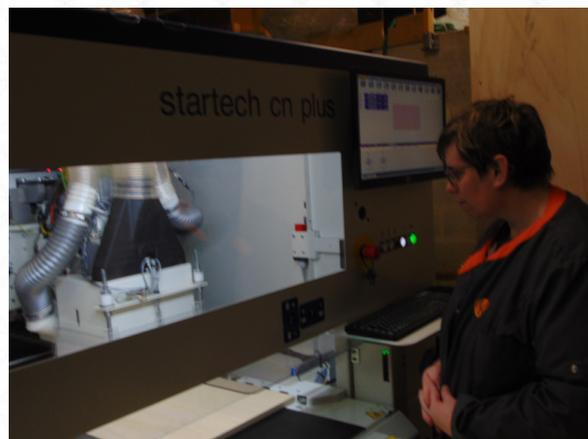
Centre d'usinage en menuiserie
